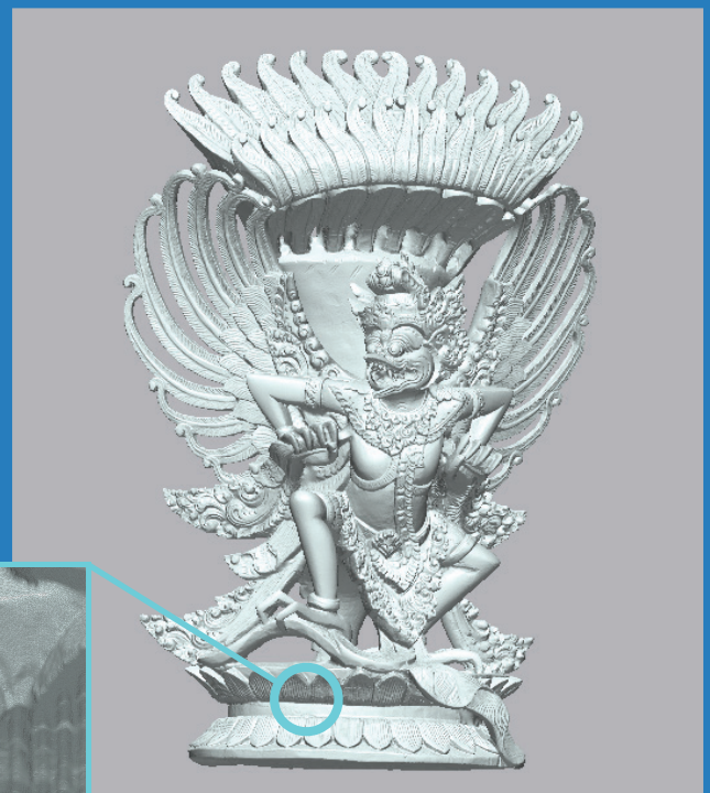
HD Scan mode mit high detail function des EinScan Pro 2X 2020 (Res: 0.2mm)
