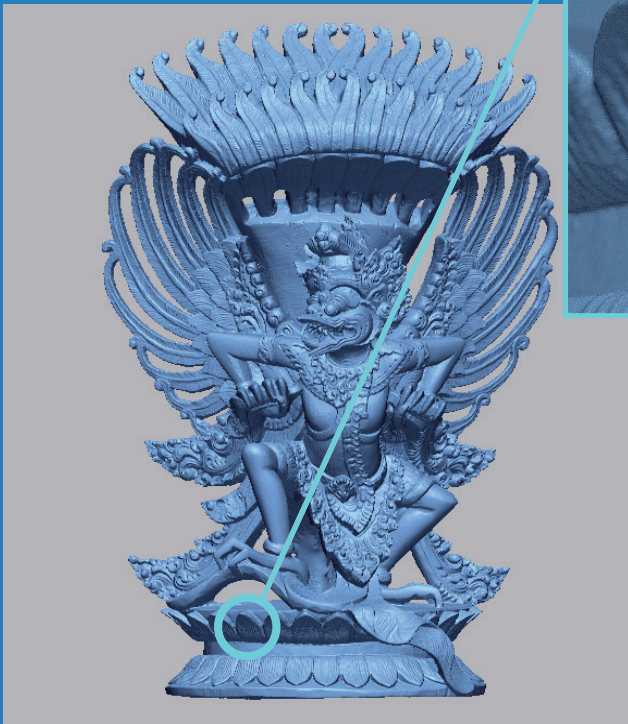
HD Scan mode mit high detail function des EinScan Pro HD (Res: 0.2mm)
